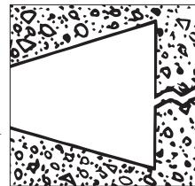
S'il n'y a pas d'eau qui coule, mouiller le béton avec de l'eau propre pour créer une surface saturée sèche (SSS).
