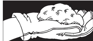
**Pour arrêter l'eau qui coule:** Commencer par remplir le haut de la fissure ou du trou, en travaillant vers le bas. En cas de forte pression d'eau, percer un ou plusieurs trous d'évacuation, qui seront bouchés avec EASY PLUG® par la suite, une fois que la fuite principale sera arrêtée.
