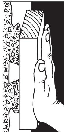
**Pour fixer des objets en métal:** Centrer la pièce ou le boulon dans le trou, en laissant au moins 13 mm tout autour. Immobiliser la pièce si nécessaire, tasser EASY PLUG® tout autour et lisser la zone de réparation au ras de la surface. EASY PLUG® durcira dans 60 secondes et peut supporter une charge après 6 ou 7 heures de séchage.
