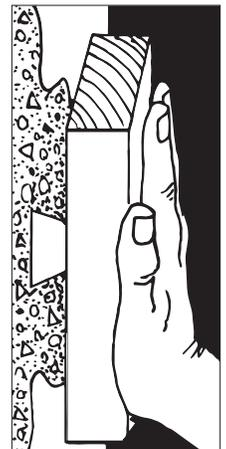
**Para anclar objetos de metal:** Coloque la pieza o el perno en el centro del agujero, dejando al menos 13 mm alrededor. Inmovilizar el objeto si necesario, encerrar con EASY PLUG® y alisar alrededor a ras con la superficie reparada. EASY PLUG® se endurecerá en 3-5 minutos y puede soportar el peso en 6 a 7 horas.
