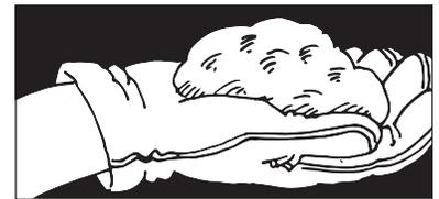
**Para detener filtraciones de agua:** Comenzar por llenar la parte superior de la grieta o agujero, trabajando arriba hacia abajo. En caso de alta presión de agua, perforar uno o más agujeros de drenaje que se pueden rellenar con EASY PLUG® después, una vez que se detenga la fuga principal.
