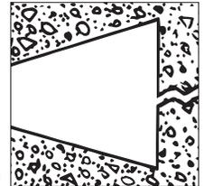
Eliminar la suciedad y los escombros. Si no hay agua corriente, humedecer el concreto con agua limpia para crear una superficie saturada seca (SSS).
